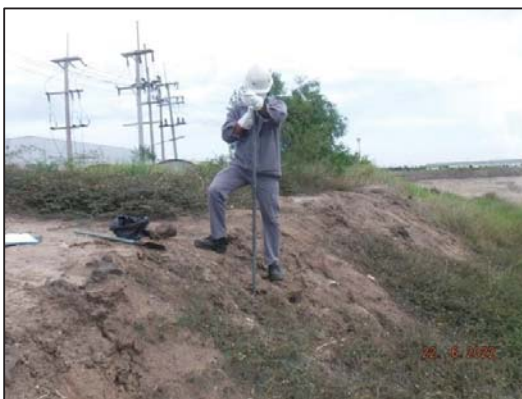
รูปที่ 3.12 การเก็บตัวอย่างวิเคราะห์ลักษณะสมบัติของดิน ที่ระดับความลึก 0-50 เซนติเมตร
