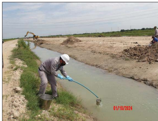
รูปที่ 3.14 การเก็บตัวอย่างน้ำบ่อพักน้ำทิ้งในพื้นที่ก่อสร้างที่จะนำมาใช้ประโยชน์
