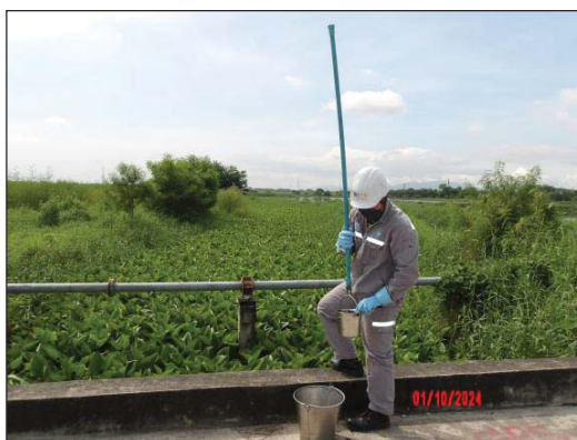
รูปที่ 3.17 การเก็บตัวอย่างแหล่งน้ำในพื้นที่โครงการและโดยรอบ บริเวณ คลองบางแสม (SW3)
